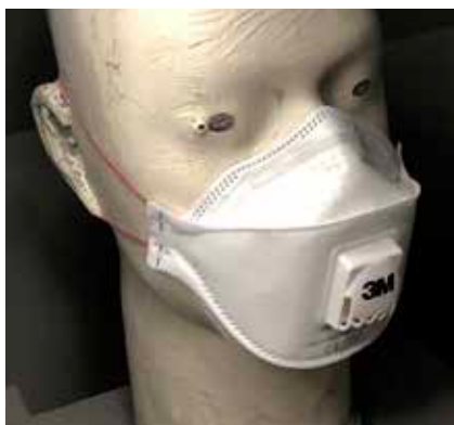
Slika maske na umetni glavi, namenjeni za testiranje filtracijske učinkovitosti
