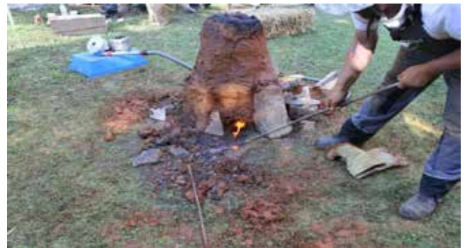
Slika 8: Utrinek z Metalurškega dne 25. 08. 2020: prikaz tehnike taljenja železove rude na starodoben način na vrtu Narodnega muzeja Slovenije [4]
