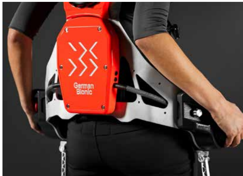
Inteligentni eksoskelet Cray X s povezavo IoT za pametne tovarne (vir: German Bionic)
