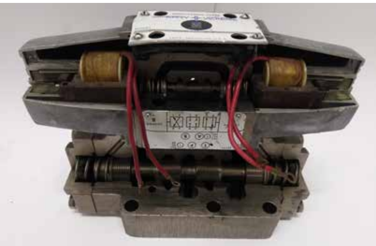
Slika 2 : Prerezan dvostopenjski potni ventil
