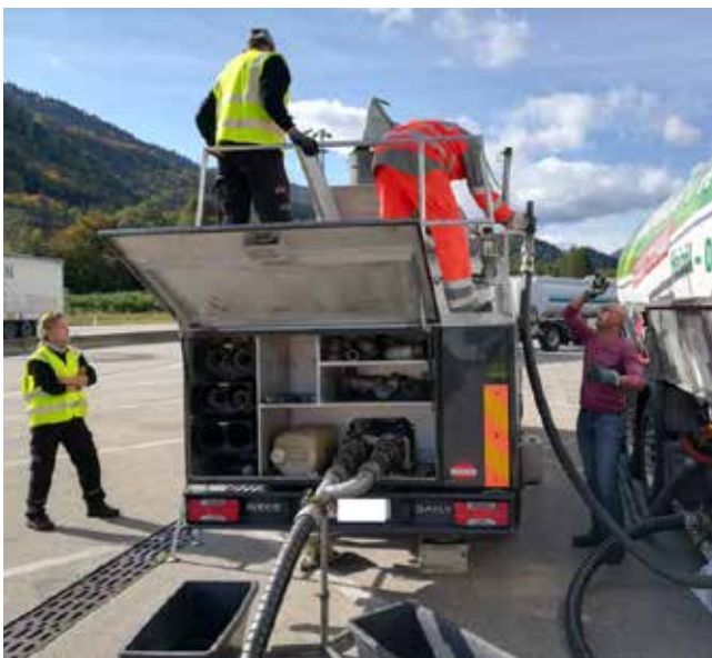
Slika 1: Nadzor merilnega sistema na tovornem vozilu za prevoz goriva
