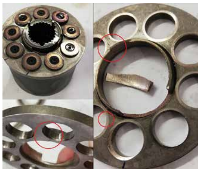
Slika 1 : Poškodovani del aksialne batne črpalke: boben z bati, drsnimi čevlji in delilno ploščo (zgoraj levo) in poškodovana delilna plošča (spodaj levo in desna slika) [4]
