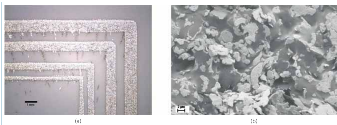
Slika 1: (a) 8-kratna povečava odtisov, natisnjenih s sitom 62-64 na tiskovnem materialu Pe:smart. (b) Odtis s prevodno tiskarsko barvo in sitom 62-64 na tiskovnem materialu Pe:smart. Svetlejši deli predstavljajo srebrove luske, temnejši pa vezivo tiskarske barve, ki pokriva srebrove luske.
