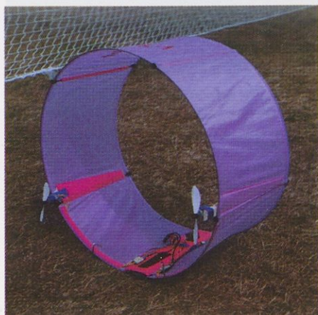
Nizko nameščena motorja in deli RV-opreme zagotavljajo obročastemu krilu zadostno stabilnost, da lahko leti. Z dodajanjem in odzemanjem plina obeh ali posameznega motorja se model vzpenja ali spušča oziroma zavija.
