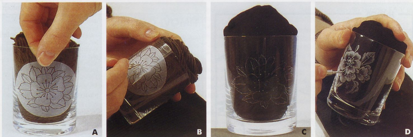
Slika 2. Motiv, ki ga nameravate vgravirati, s tankim flomastrom prerišite na pavs papir in ga prilepite na notranjo stran kozarca (a). Z diamantnim brusom zgravišite obris motiva (b). Pavs papir nadomestite z listom črnega papirja ali črno krpo, saj so zgravirane črte na temni podlagi najbolj vidne (c). Sledi dokončna obdelava motiva, senčenje oziroma matiranje (d).
