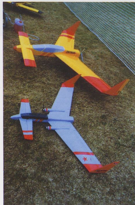
Tudi konstrukcije "raček" privlačijo graditelje. Obe na tej sliki ženejo elektromotorji. Spodnja je zanimiva predvsem zaradi svoje namestitve dveh motorjev mabuchi 380.
