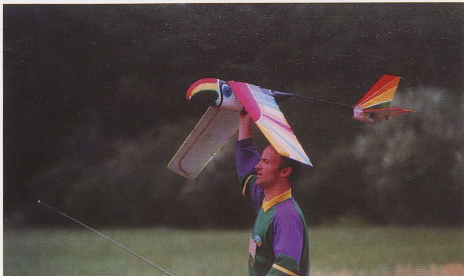
Albert Kempf in njegovo frčalo pred poletom. Krila so povsem običajne letalske konstrukcije z izrazito nizko skrajno spodnjo lego, zelo različna od drugih poskusov te vrste.
