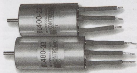
Brezkrtačni motor spoznamo po treh žicah, ki vodijo iz motorja. Slika prikazuje Kontrolnikova motorja BL400 in BL480. Kot nakazuje že samo ime, sta alternativa motorjema speed 400 in 480, imata pa precej boljše zmogljivosti.
