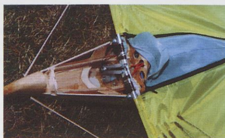
Podrobnosti mehanizma kril mahokrilca Thea Gordijna
