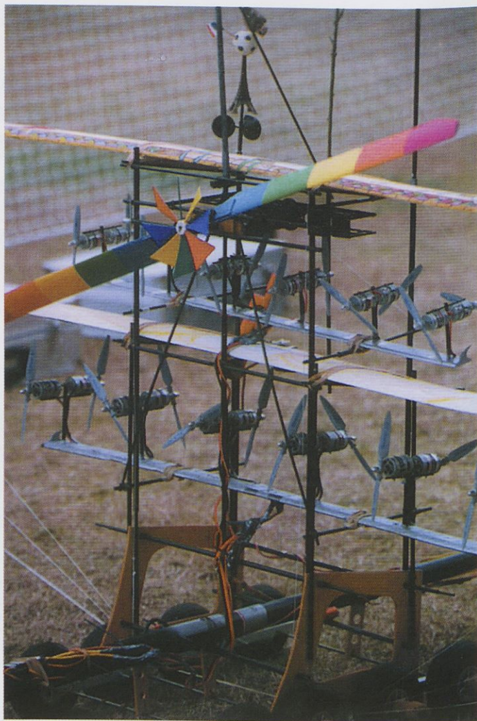
Peter Haas iz Berlina se je specializiral za gledalcem zanimive velike modele s strukturo iz karbonskih letvic, ki nosijo (skoraj) običajno krilo. Ta, imenovan po priljubljeni francoski pevki Edith Piaf, je bil zgrajen za podobno srečanje pred dvema letoma v Franciji (slika spodaj). Izjemen vtis naredi pogon modela z nič manj kot štiriindvajsetimi Graupnerjevimi motorji speed 400 (slika zgoraj).
