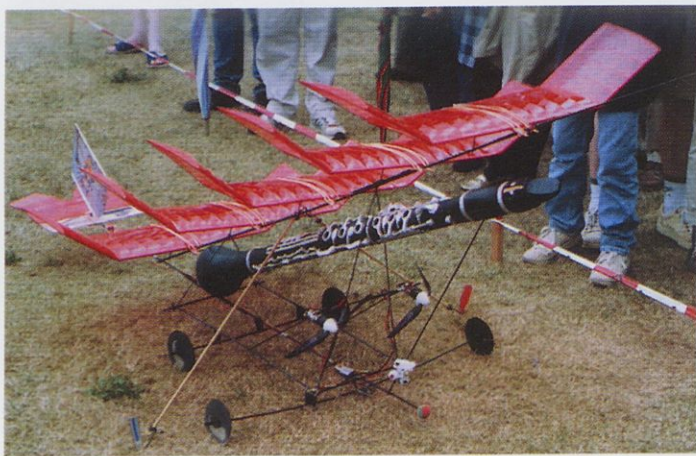
Leteči klarinet s petimi krili na tleh in v zraku. Za pogon uporablja dva elektromotorja (sliki zgoraj in spodaj).
