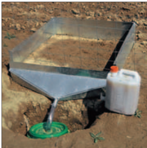
Slika 73: Erozijsko polje 1 na goli prsti v mladem oljčniku in površinski odtok, ki je bil ujet v lovilno posodo v tednu med 7. 4. in 13. 4. 2005. Odtok je prelit v posodo s prostornino 10l.
