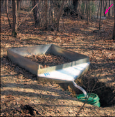
Slika 81: Erozijsko polje 5 v gozdu z manjšim naklonom; zadaj desno z rdečo puščico označeno erozijsko polje 6.
