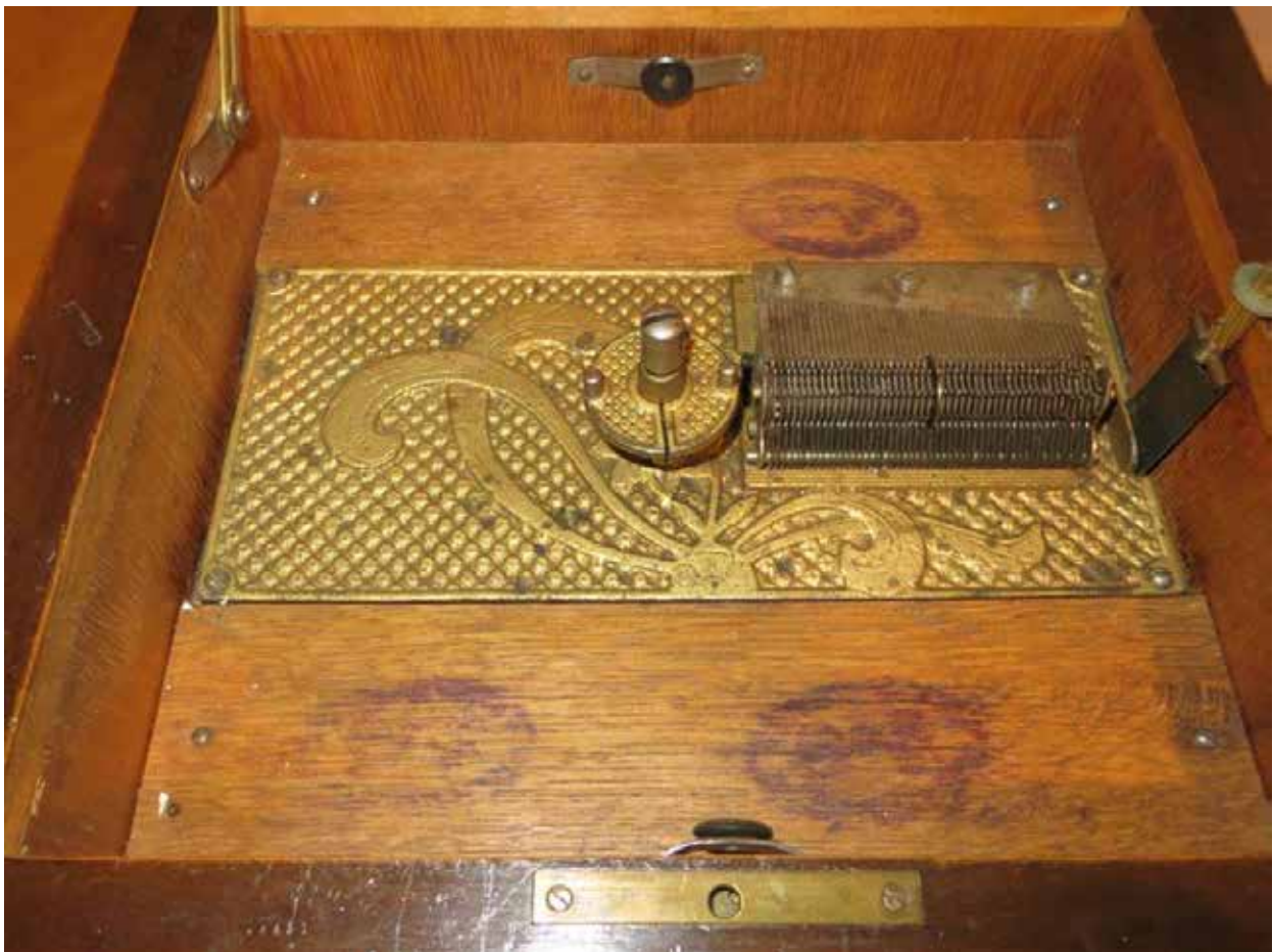
Detajl: glavničasta lamela, nad katero namestimo kovinski disk, foto: Brane Lamut.
