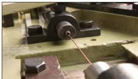
Podajanje žice: Puša za pomik (spodaj) in puša za pridrževanje (zgoraj). Foto: Andrej Bogataj
