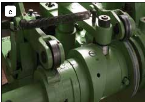
Gibanje so omogočali ekscentri, pritrjeni na pogonsko gred. Foto: Andrej Bogataj
