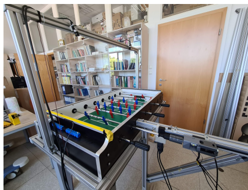
Slika 8: Pogonska enota in kamere z osvetlitvijo
