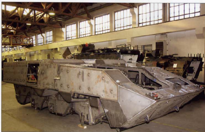
Kmalu bodo iz tovarniških dvoran prišla vozila nove vrste krpan. Na posnetku je sklopka novega vozila
