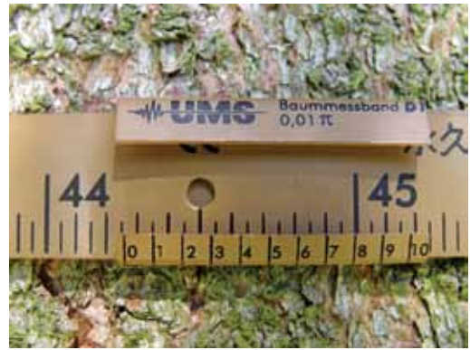
Slika 1: Spremembe v premeru debla odčitavamo na desetinko milimetra natančno, kar omogoča nonijska skala. Drevo na fotografiji v premeru meri 44,25 cm.
