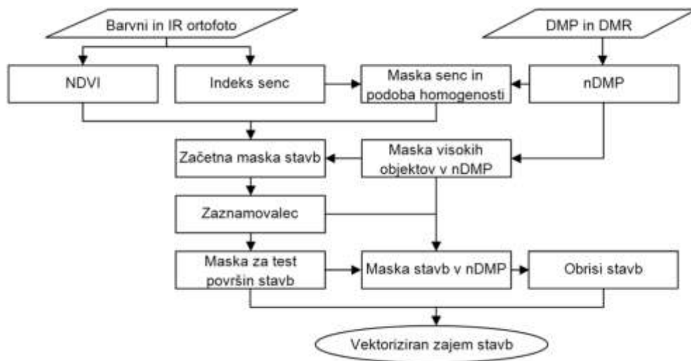
Slika 2: Diagram poteka zajema stavb iz DMP in DOF.
