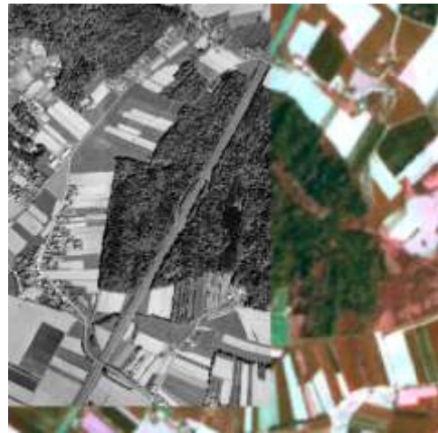
Slika 72: Primerjava položajne natančnosti ortorektificiranega satelitskega posnetka SPOT5 z aero DOF5 (CAS)
