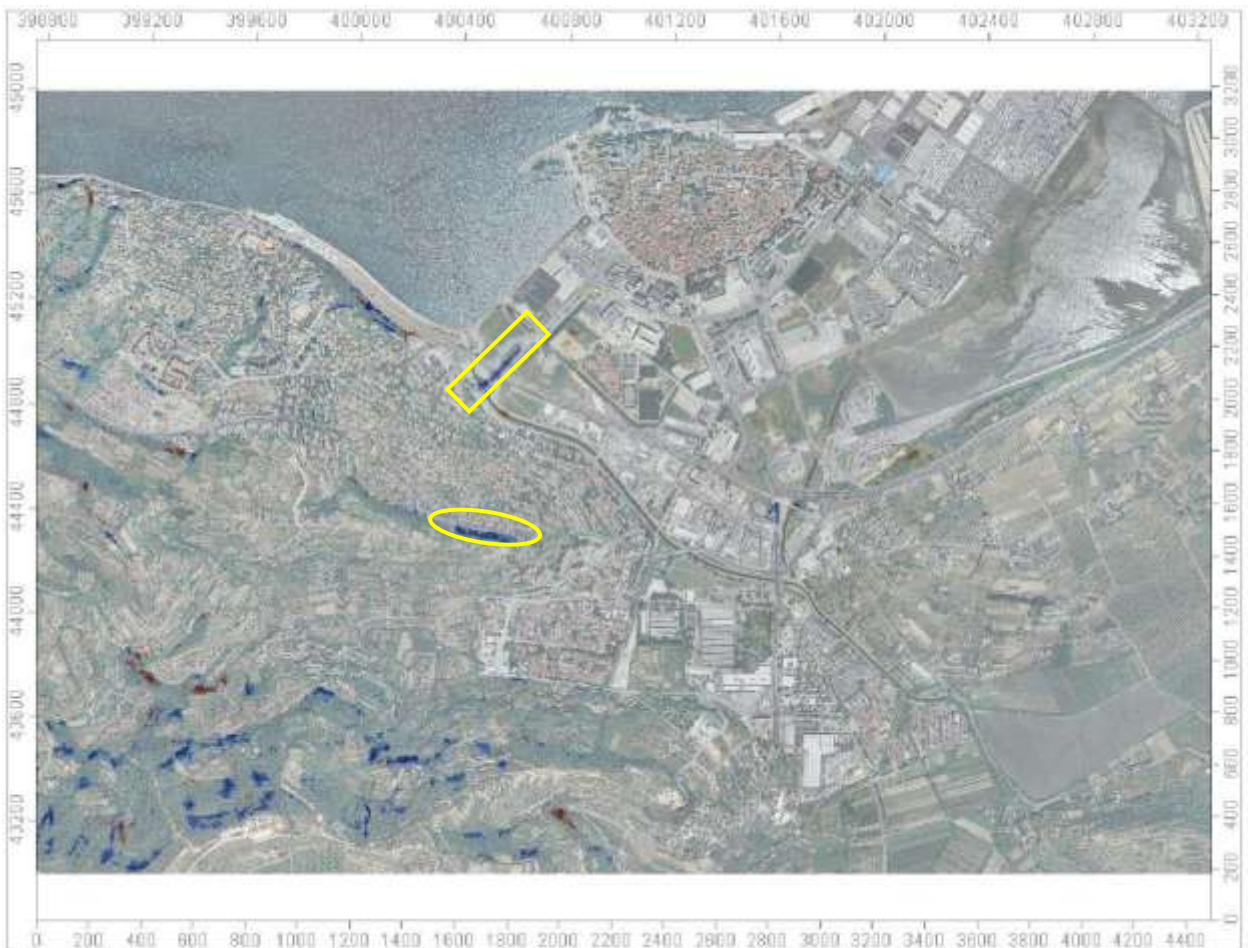
Slika 40: Primerjava višin DMR LSA 2011 z višinami referenčnega DMV5 2006, območje Koper. Rumena elipsa oziroma rumeni kvadrat označujeta omočja spremembe terena zaradi izgradnje hiš oziroma ceste.
