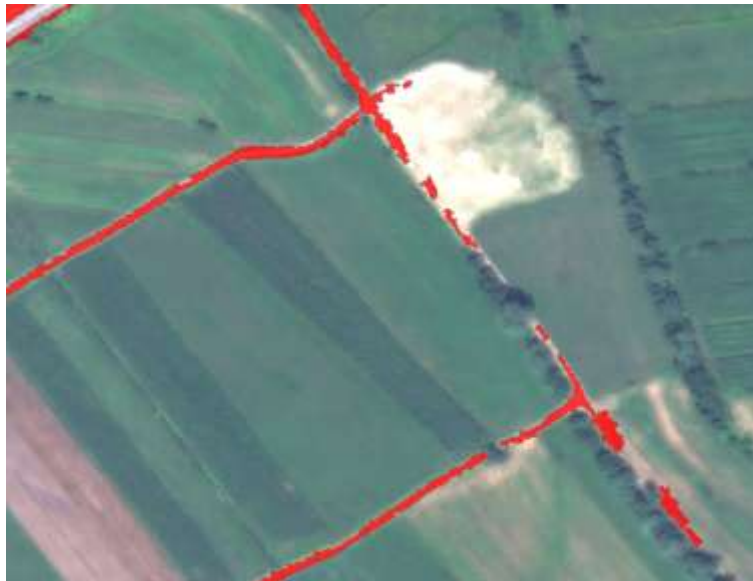
Slika 58: Primer nezveznosti zajema cest zaradi vegetacije, ki na posnetku sega čez cestne objekte.
