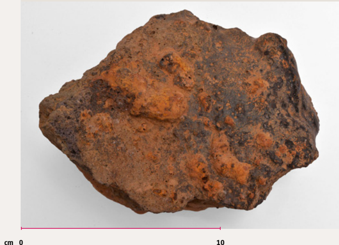
75 Kaplje železa na notranji površini jaška peči, ki nastanejo na delu peči nad vnosom zraka, in pod območjem, kjer iz rude nastaneta in se ločujeta železo in žlindra, vzorec V 3.
