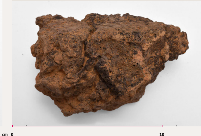
78 Ena stranica vzorca V 4 je ravna, na drugi pa so vidne razpoke med kepama gline iz katere so zgradili steno peči. Kepe gline so se med taljenjem ločevale in zato so se stične površine zapekle in ohranile.
