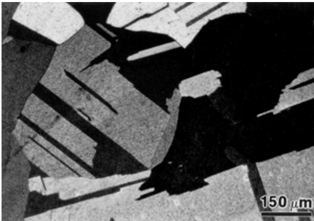
Slika 5: Mikrostruktura gašenega čistega Cu Figure 5: Microstructure of quenched pure Cu
