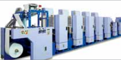
Polrotacijski tiskarski sistem suhega ofsetnega tiska za tisk etiket.
