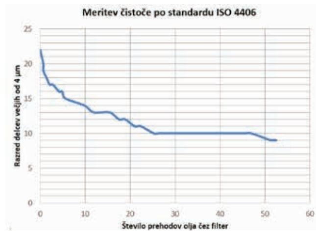
» Slika 2: Meritev čistosti hidravličnega olja pri filtraciji z mobilno filtrirno enoto LFT v odvisnosti od števila prehodov skozi filter.
