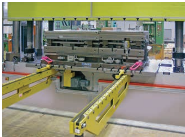
» Menjalna postaja ROEMHELD za orodja do 32 ton je zaradi elektromotornih nosilnih konzol varna rešitev za hitro menjavo orodja in se lahko uporablja na več stiskalnicah naenkrat (fotografija: ROEMHELD).
