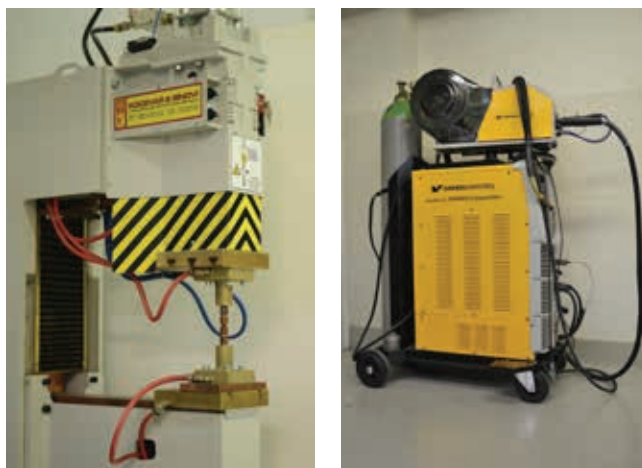
» Stroj za uporabno varjenje podjetja Kočvar & sinovi, d. o. o., z virom varilnega toka iz podjetja Indramat elektromotorji, d. o. o. (levo), vir varilnega toka za varjenje MIG/MAG donacija podjetja Daihen Varstroj (desno).
