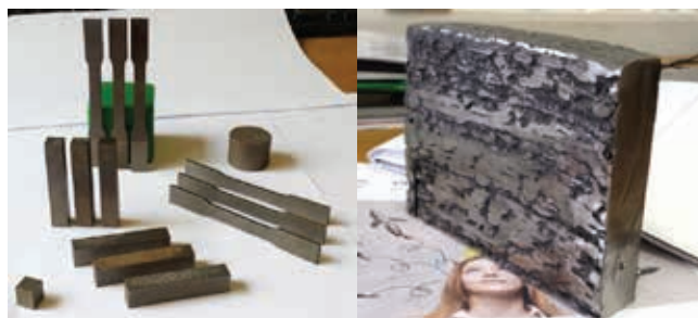
» Levo – vzorci za določanje lastnosti SLM-tiska; desno – navarjena stena, iz katere smo izrezali vzorce za določanje lastnosti WAAM- tiska
