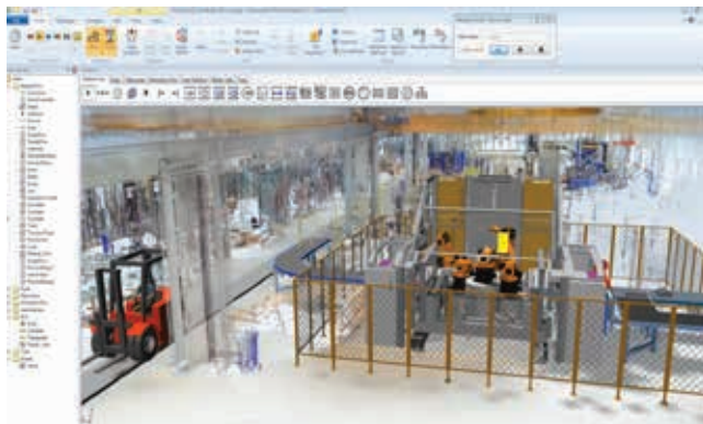
» Ena izmed možnih vizualizacij proizvodnje v programski opremi Tecnomatix Plant Simulation vključno s Point-Cloud okoljem (3D-skenirana proizvodnja)
