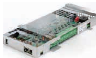
» Varnostni krmilnik določa definirano tridimenzionalno delovno območje robota.
