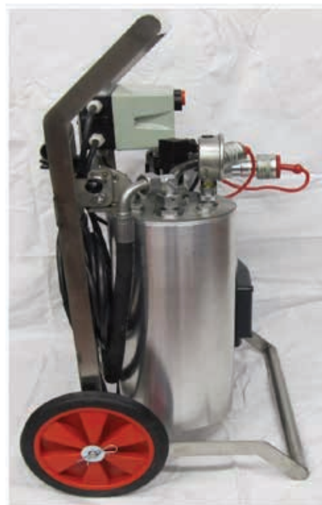
» Slika 1: Mobilna filtrirna enota izdelana v Laboratoriju za fluidno tehniko (LFT).
