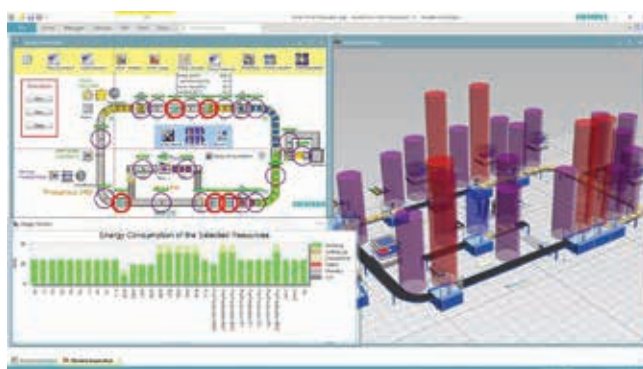
» Simulacijski 2D in 3D model (digitalen dvojček) proizvodnje – poročilo porabe električne energije v programski opremi Tecnomatix Plant Simulation
