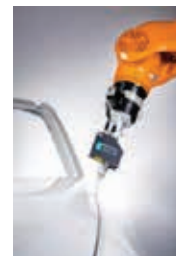
» Visoko precizna korekcija poti robota s sistemom VMT BK in laserskim sekcijskim svetlobnim senzorjem.
