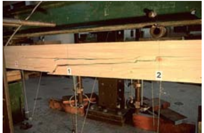
Slika 4: Porušitev natezne cone lameliranega lepljenega lesenega nosilca iz običajne II. kvalitete lesa. Damage on a laminated glued timber beam of ordinary II. quality timber in its tension zone.
