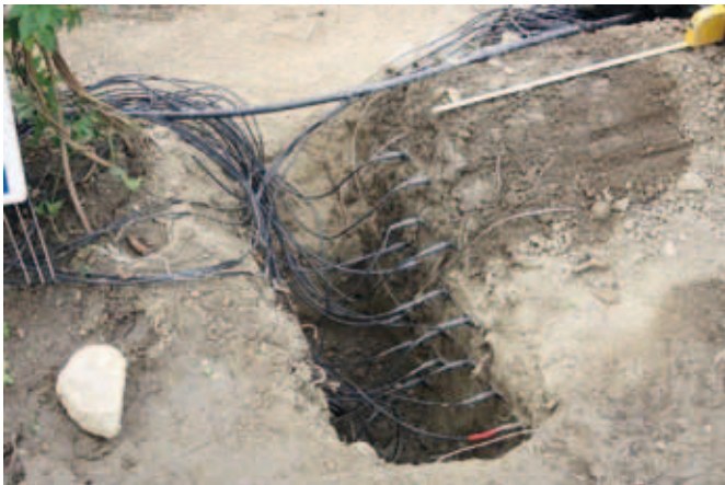
Eksperimentalno določanje pomikanja vode v tleh v hmeljišču pod kapljačem površinskega kapljičnega namakalnega sistema (Foto: B. Naglič)
