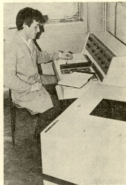
IR spektrofotometer in NMR spektrometer za analiziranje tipov in sestav različnih veziv, pigmentov in polnil
