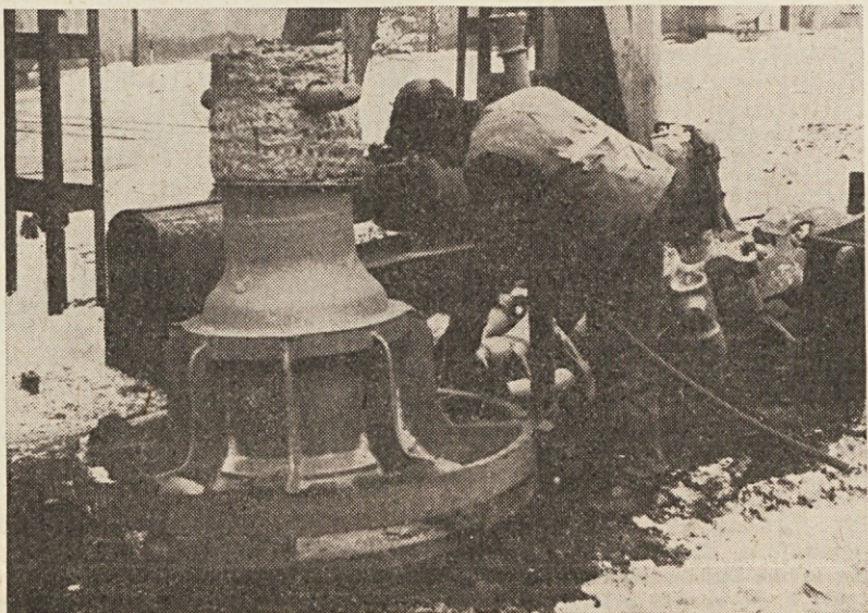
Tehnologija formanja z umetnimi smolami je dvignila produktivnost v oblikovalnici, zagotavlja visoko kvaliteto površin in točnost dimenzij. V mnogočem je olajšala tudi težko delo pri čiščenju ulitkov (Foto: E. L.)
