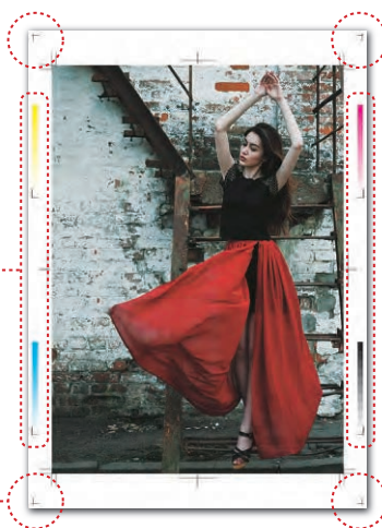
Princip delovanja zveznega nadzora barvnega in obojestranskega skladja.
