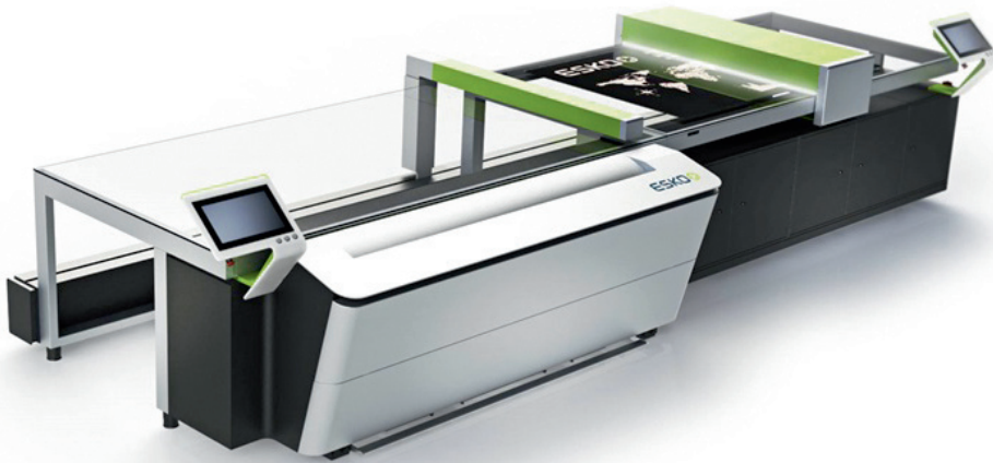
Kombinacija osvetljevalne enote CDI Crystal 5080 in dodelavne XPS Crystal 5080 zagotavlja celotno avtomatizirano izdelavo fleksotiskarskih form.
