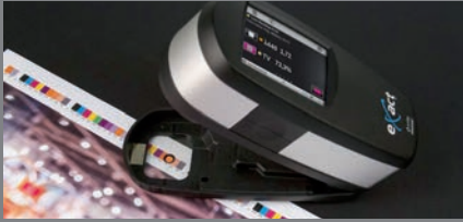
Prenosni spektrofotometrni instrumenti serije Exact z novo mersko funkcijo SCTV.
