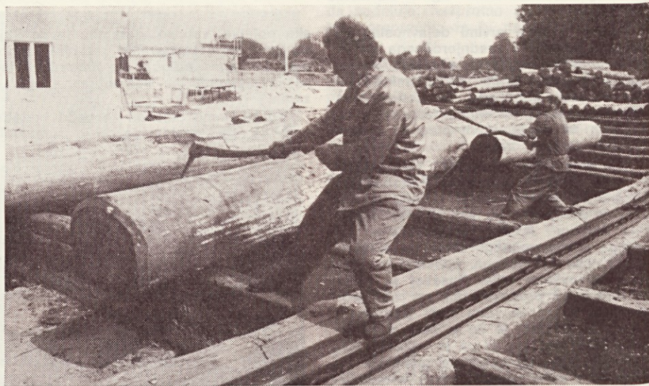
Za težaška delovna mesta je vedno težje dobiti delavce. V Stolu imamo še precej takih del, ki jih je potrebno opraviti ročno. Mednje spada tudi valjenje hlodov na transporter pred polnojarmenikom.
