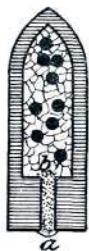
Slika 3. Prez skozi model šrapnela, napolnjenega z razstrelivom in svinčnimi kroglicami. ab je cev, nabita z lenim sestavkom. Topov ogenj zažge v trenutku strele zmes pri a , ki gori v smeri proti b , kamor prigorela zaneti razstrelivo v šrapnelu.
