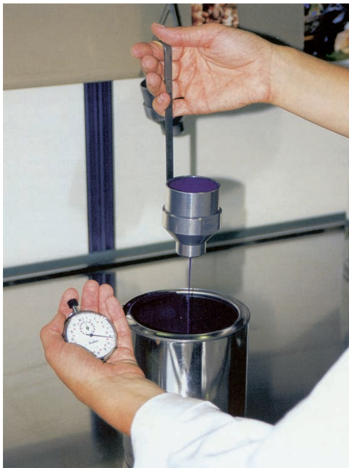
Slika 38. Merjenje viskoznosti fleksotiskarske barve.
