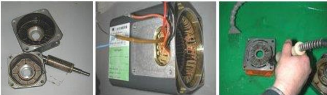
SLIKA 7: Odstranjevanje olja in maščob z aluminijastih delov. Deli pri tem niso bili načeti (razjede).
