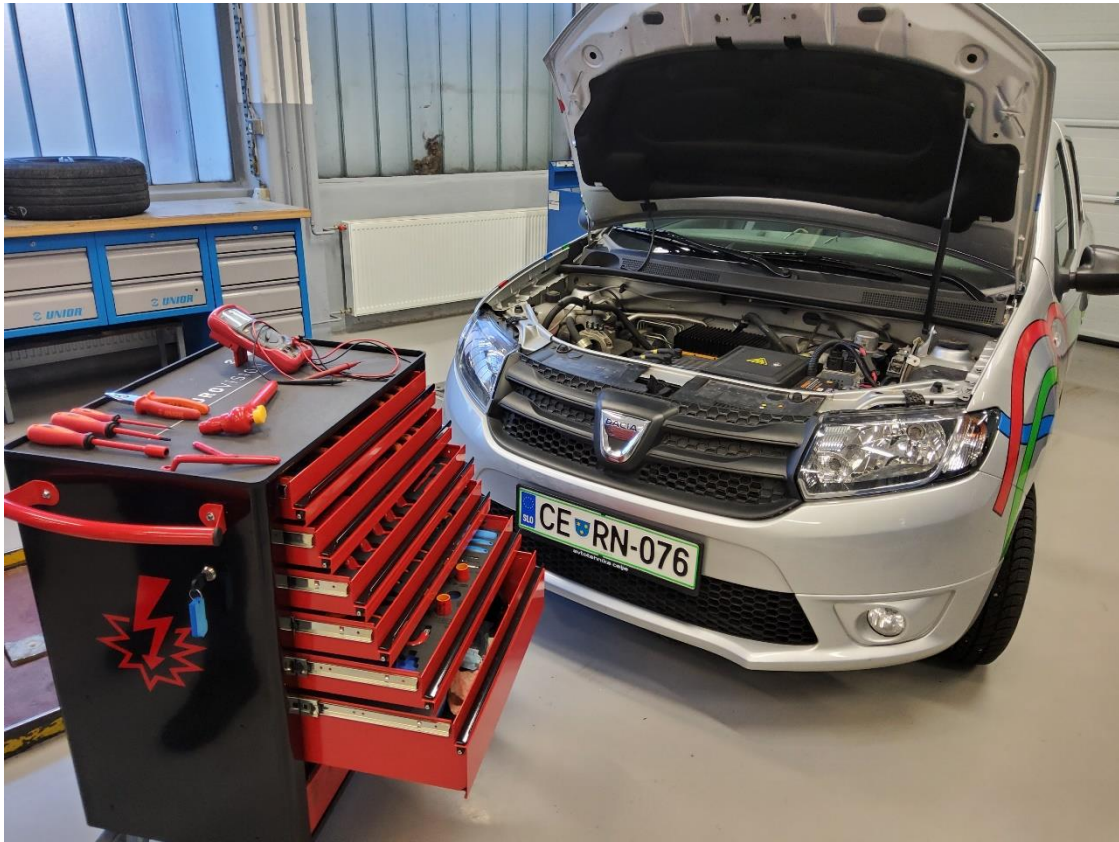
SLIKA 1: Predelano vozilo Dacia z varovalnim orodjem.
