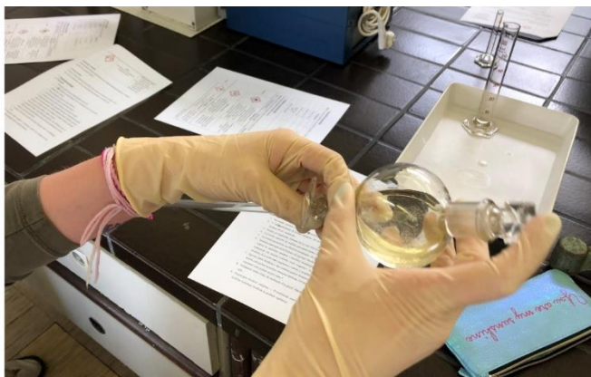
SLIKA 5: Mešanje zmesi v liju ločniku (lasten vir).
