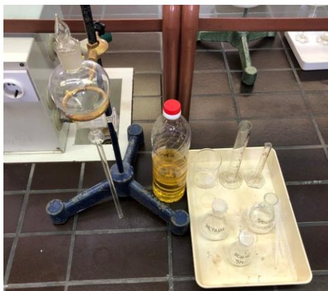
SLIKA 4: Pripomočki in kemikalije za sintezo biodizla (lasten vir).
