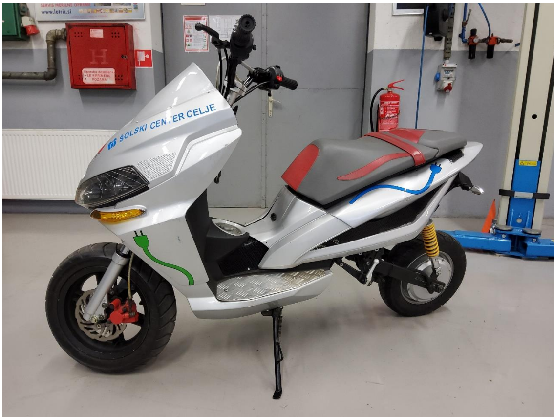
SLIKA 2: Slika skuterja predelanega na električni pogon.
