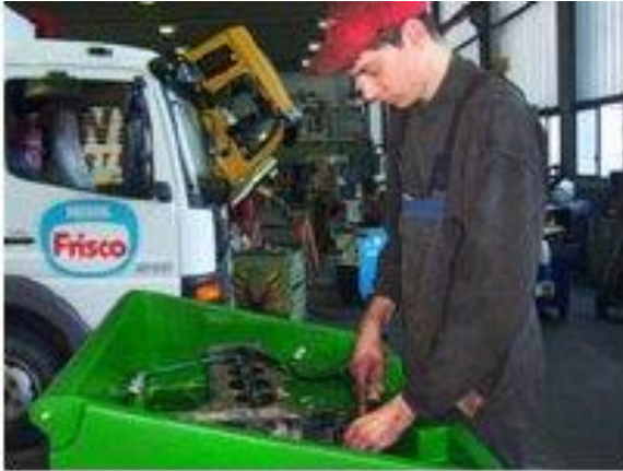
SLIKA 4: Čiščenje v okviru vzdrževanja motorja in njegovih delov. Bio-circle učinkovito nadomesti dosedanja čistila
