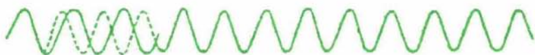
Slika 3. Nihanje električnega toka (levo) se ujema z nihanjem glasbenih vilic z enako frekvenco. Braun je oboje opazoval z vrtečim se zrcalom.
