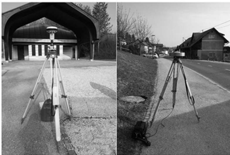
Slika 4: Statična metoda izmere GNSS na delovišču Dobrova z instrumentoma Leica Viva GS15 (levo) in Javad Triumph LS10 z zunanjo anteno (desno).
