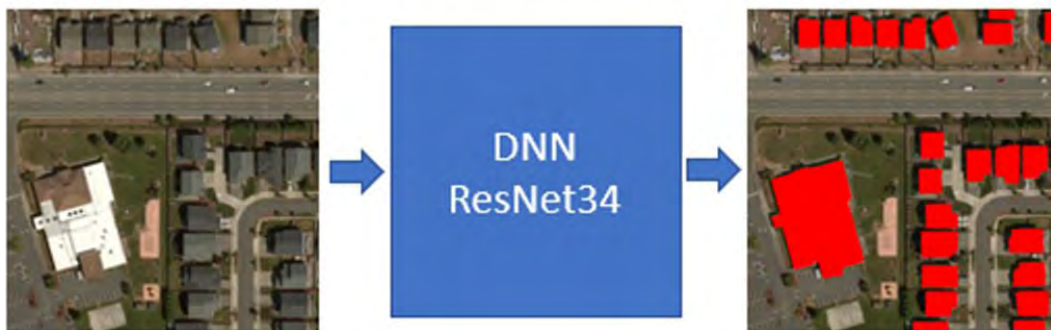
Slika 2: Prva stopnja – pomensko razločevanje slikovnih vsebin z globokimi nevronskimi mrežami (DNN) in prednaučenim slikovnim modelom ResNet34 (vir slike: https://github.com/Microsoft/USBuildingFootprints/ ).
