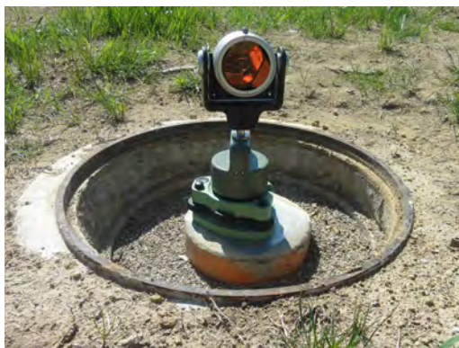
Slika 7a: Točka zavarovalne mikromreže.
