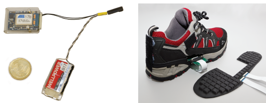
Slika 2: Slika levo prikazuje popolnoma nosljivo miniaturno inercialno merilno enoto z lastnim napajanjem (izdelano s komponentami MEMS). Slika desno prikazuje brezžične merilne podplate, vgrajene v merilno obutev.
