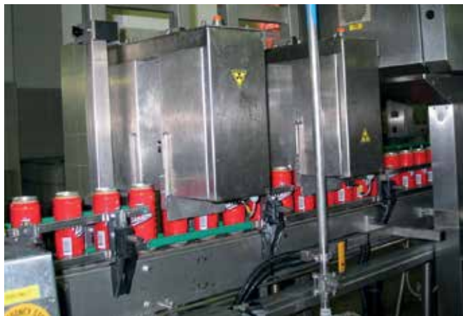
Slika 1: Merjenje nivoja tekočine v pločevinkah pijače.
