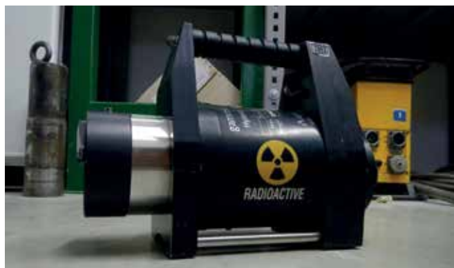
Slika 2: Zaščitni vsebnik z radioaktivnim virom za izvajanje industrijske radiografije.
