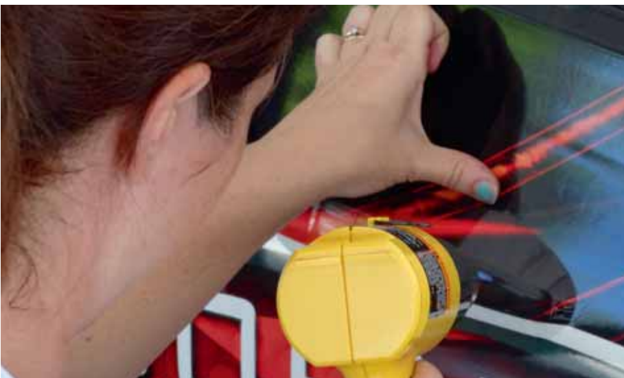
Nameščeno folijo moramo toplotno obdelati. V ta namen se uporablja posebna toplotna pištola (Heat-Gun) in nikakor običajen gorilnik.
