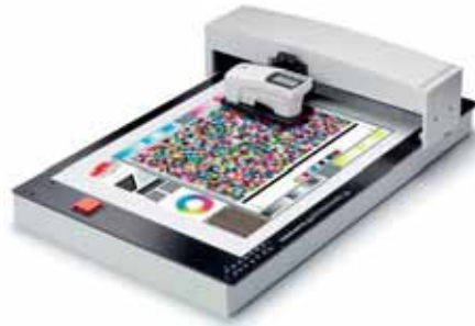
Merilna miza ColorScoutA+ omogoča natančne in hitre meritve.
