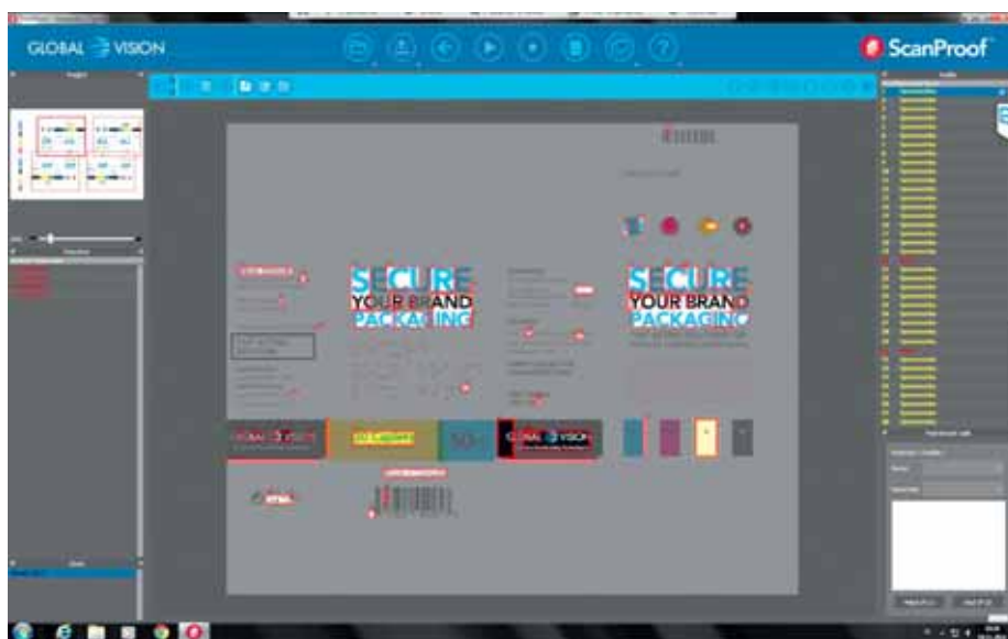
Slika 2: Pogled na vmesnik po zagonu verifikacije. Spremembe so označene rdeče in našteje v desnem stolpcu odstopanj. Uporabnik izvede pregled ene ali več sprememb naenkrat in jih doda ali izloči iz poročila.
