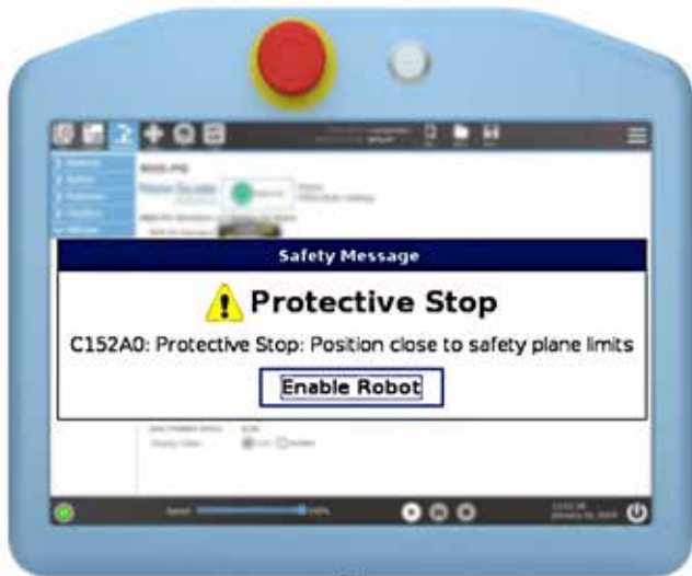
Slika 8 : Zaščitna zaustavitev robota blizu mejne ravnine.
