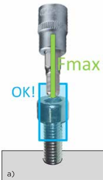
Slika 5 : Zaznavanje prisotnosti in pravilnega položaja vijaka; a) robot zazna vijak na pričakovanem mestu, b) robot zazna odsotnost vijaka, c) robot zazna napačno pozicijo
