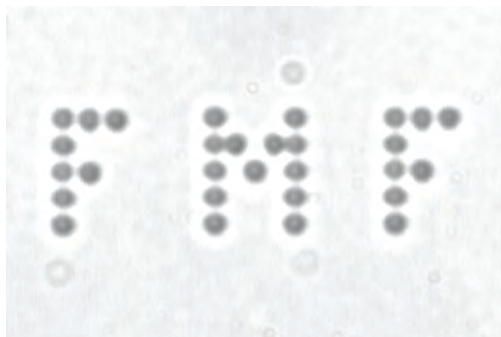
Slika 4: Mikroskopska slika množice steklenih mikrokroglic v vodi, ki so ujete v optičnih pasteh. Velikost posamezne črke je približno 10 mikrometrov. Celotni videoposnetek si lahko ogledate na spletni strani http://tweezers.fmf.uni-lj.si/opticna-pinceta/ .
