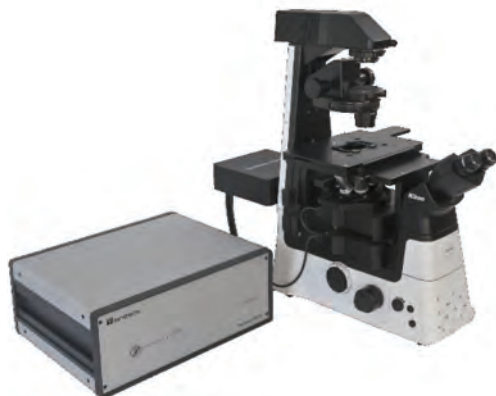
Slika 5: Optična pinceta slovenskega podjetja Aresis. Komercialnemu invertnemu raziskovalnemu mikroskopu sta dodana laser in sistem za vodenje snopa.
