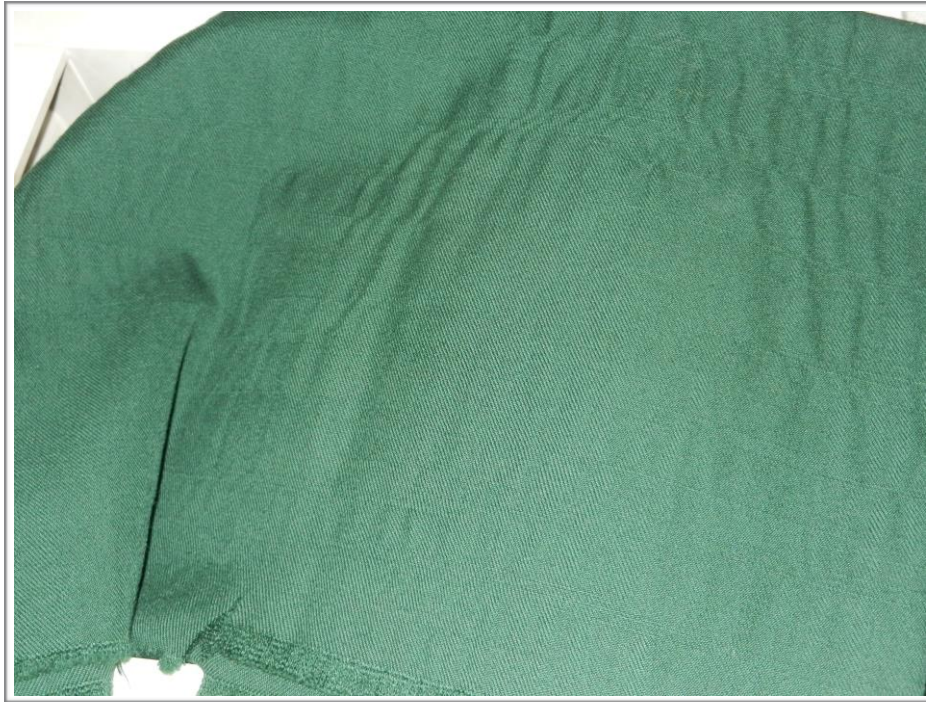
Slika 11-2: Izgled površine vunene tkanine sa napetim nitima, koje opisuje model na slici 11-1
