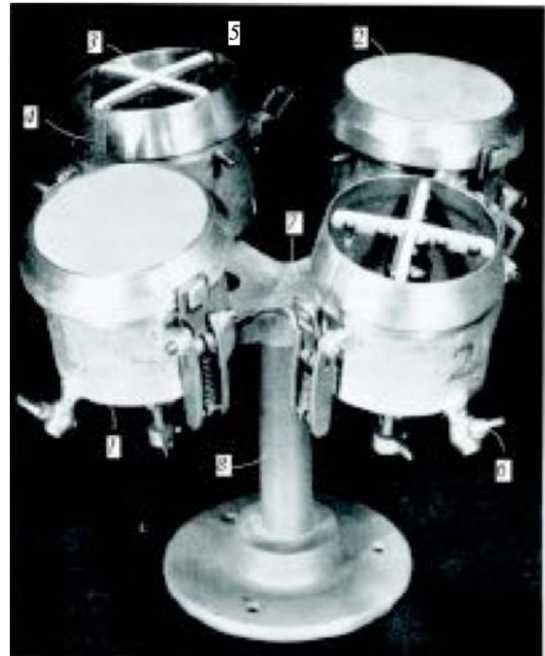
Slika 9-15: Posudice za montiranje primeraka uzorka: 1 - posudica, 2 - primerak uzorka, 3 - posudica bez uzorka, 4 - obruč za učvršćivanje, 5 - krst, koji seljulja i tare uzorak sa unutrašnje strane, 6 - ventil, 7 - krst, 8 - stalak krsta [8]
