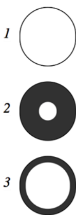
Slika 15-21: Filtracija u Cementari Trbovlje kroz vreće, koje su izrađene od iglane vlakovnine: 1 - rupa u vlaknovini, koja je posledica iglanja, pre upotrebe, 2 - stanje pre izduvavanja filtrirane prašine, 3 - izgled rupe nakon izduvavanja
