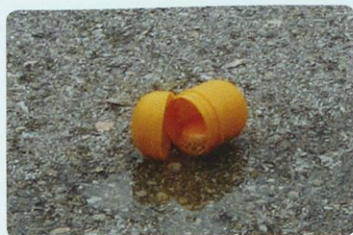
Posodica se odpre, ko je tlak plina v njej dovolj velik. Ob tem zaslišimo pok. (Fotografiji: Katarina Štilec)
