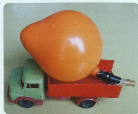
Izstrelitev rakete lahko prikažemo z modelom vozila, ki ga poganja balon. (Fotografija: Goran Iskrič)
