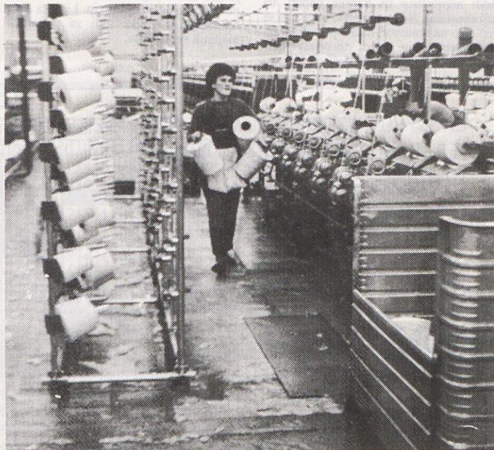
Nova cevčnica na stroju Hirschburger za predložke za novi DD sukalni stroj ALLMA v sukalnici.
