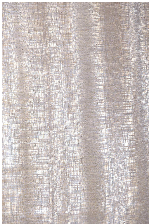
Slika 9: Izmenična zavita rast in nastanek progaste teksture na radialnem prerezu. Risba po Wilsonu in Whiteju 1986, str. 191.
