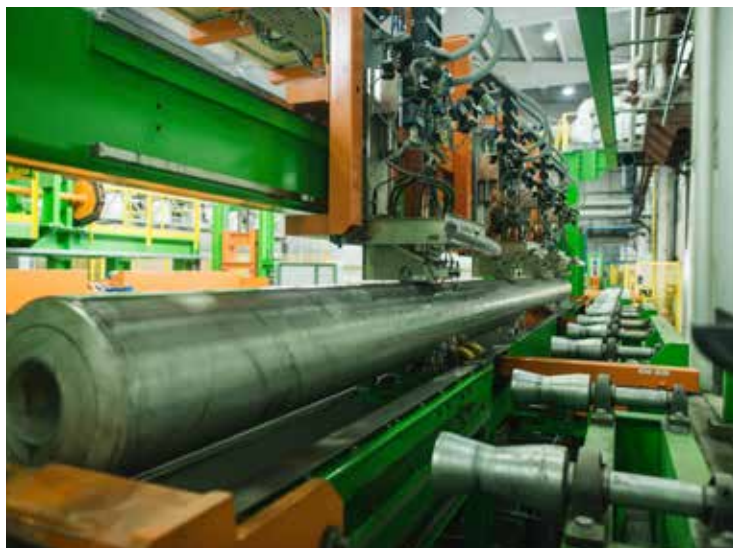
Slika 3a: Izvajanje dinamičnega testa na drogu s premerom 331 mm
