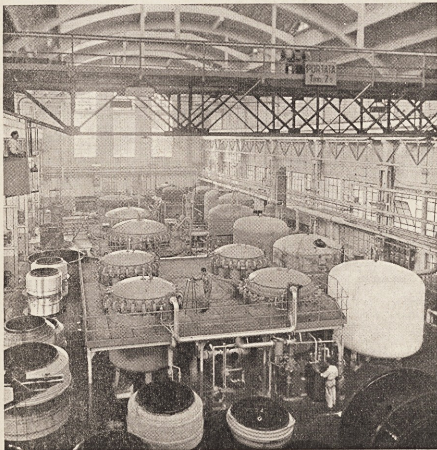
Vulkanizacija impregnacijske obloge kablov v »Pirelliju«
