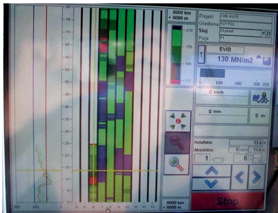
Slika 18 • Pogled na jarek za vgradnjo merilne (inklinacijske) cevi in detekcija cevi pod površino med merilnim prehodom na zaslonu BCM 05
