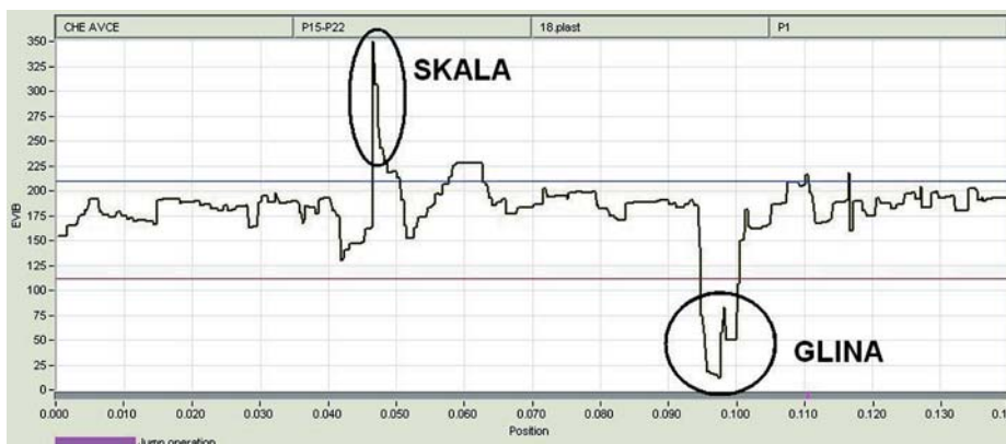
Slika 9 • Zapis dinamične merilne vrednosti in anomalij v podlagi; terameter, ČHE Avče, maj 2007
