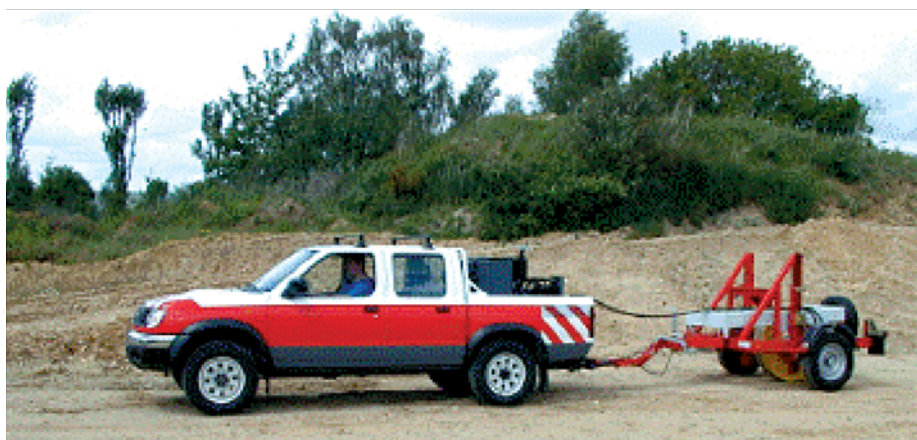
Slika 13 • Portancemeter za zvezno merjenje zgoščenosti plasti (CETE, Francija)
