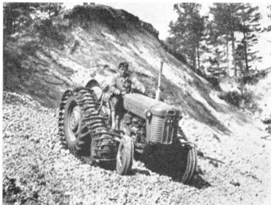
Traktor Fe 35 opremljen s polgosenicami
