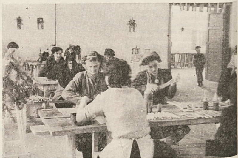
Ročna površinska obdelava obešalnikov
