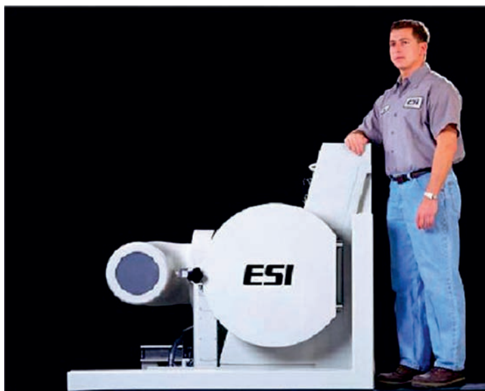
Slika 2. Dodatna naprava za utrjevanje odtisov EB.
