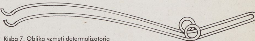
Risba 7. Oblika vzmeti determalizatorja
