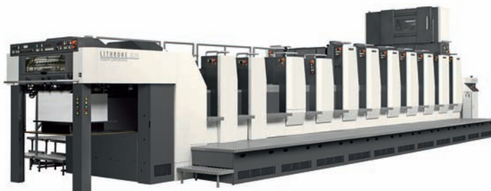
Lithrone SX 629 z napravami za tisk z metalnimi folijami, slepi tisk in UV-lakiranje.
