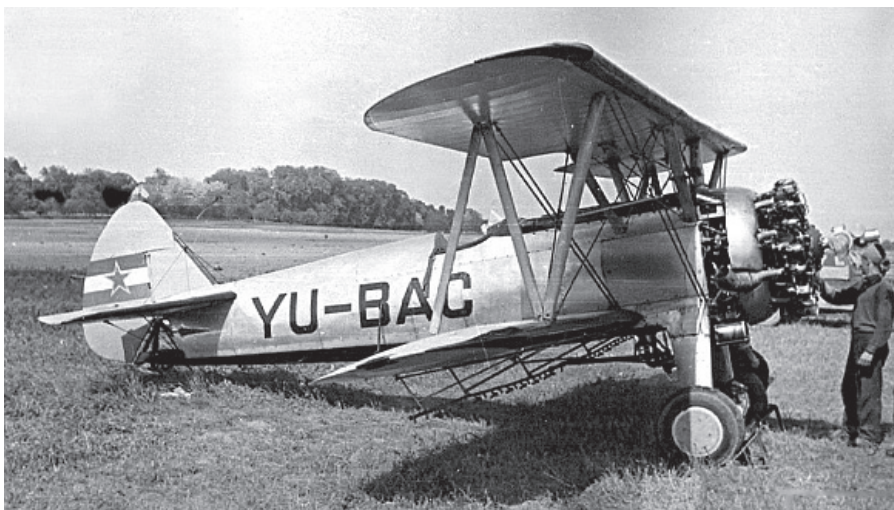
YU-BAC steerman PT-17-75 s popolno opremo za škropljenje in motorjem R-985. Nad repnim kolesom manjkajo kovinske oplate.
