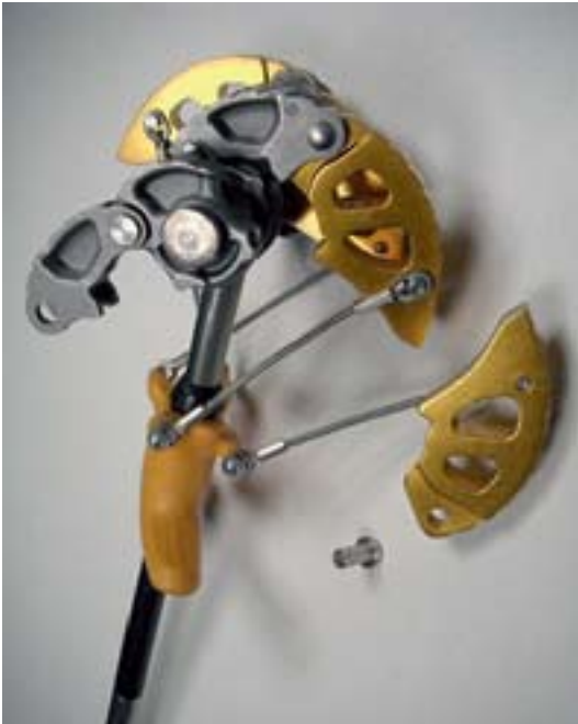
Metulj znamke Omega Pacific s pokvarjenim spojem, vir: http://www.danskbjergklub.dk/forum/
