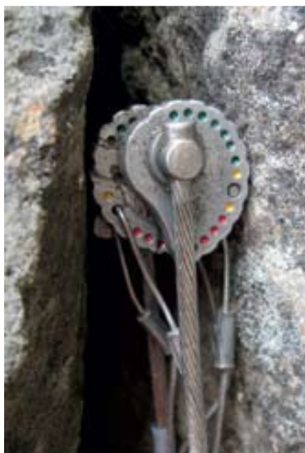
Metoliusov metulj z barvno lestvico, ki ocenjuje kakovost namestitve (zelena dobro, rumena srednje dobro, rdeča slabo).
