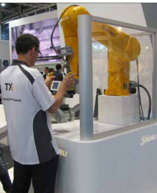
Slika 11. Ročno vodena robotska roka za pomoč pri montažnih operacijah (vir: Šimic)
