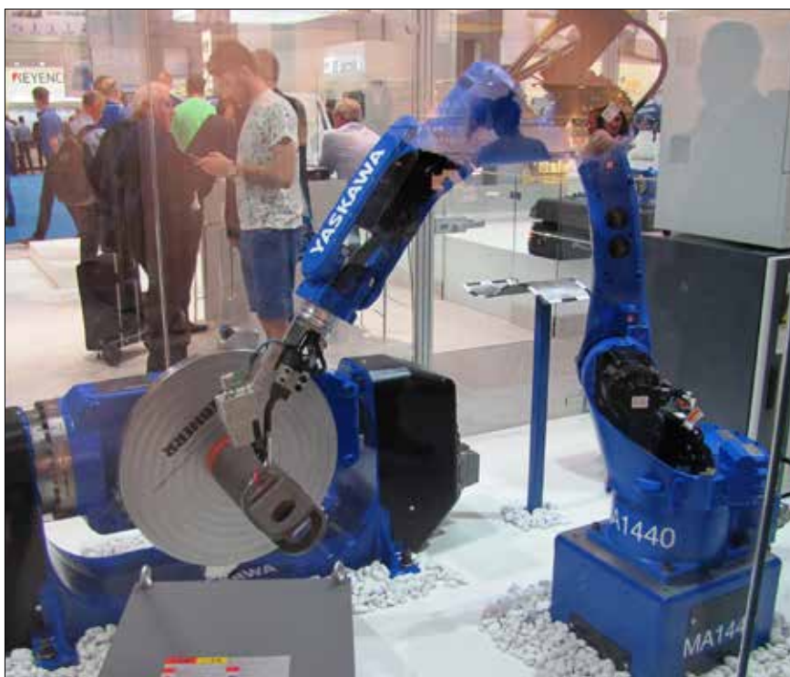
Slika 12. Precizni robotski pozicionerji v procesih varjenja (vir: Šimic)
