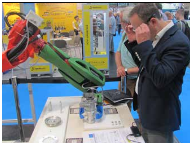
Slika 14. Vodenje robotske roke s pomočjo interaktivnih očal (vir: Šimic)
