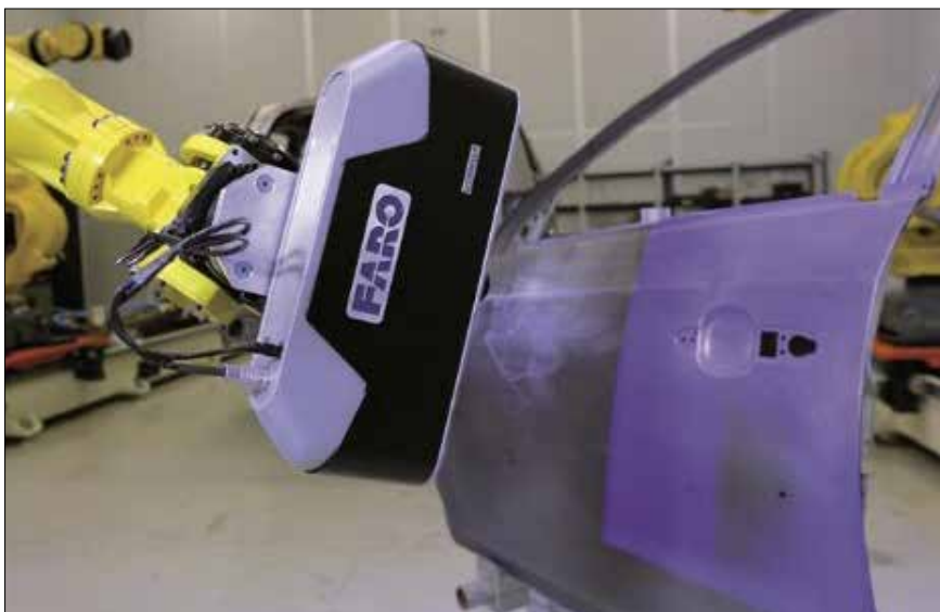
Slika 4. Skeniranje za digitalizacijo 3D-objektov (vir: Faro)
