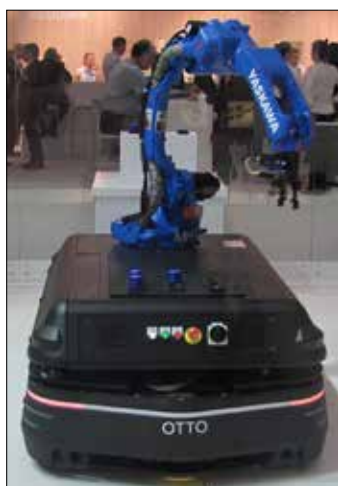
Slika 15. Avtonomno vodeni vozički v procesih strege in montaže (vir: Šimic)
