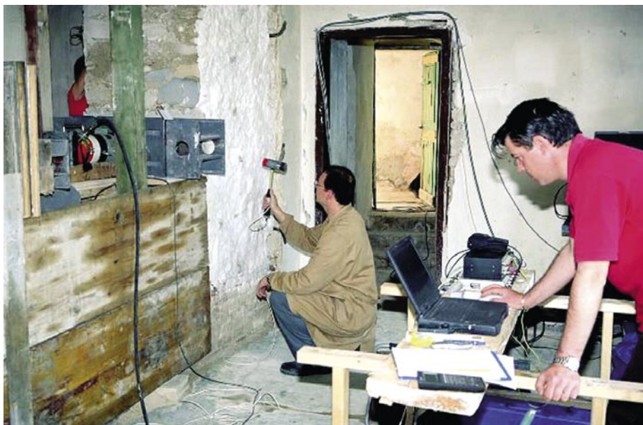
Slika 9 • Ugotavljanje homogenosti kamnitega zidovja z odmevom na udarec (arhiv ZAG, foto V. Bosiljkov)
