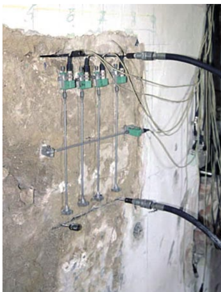
Slika 11 • Meritve tlačnih napetosti v zidu s ploščatimi bati (arhiv ZAG, foto V. Bosiljkov)
