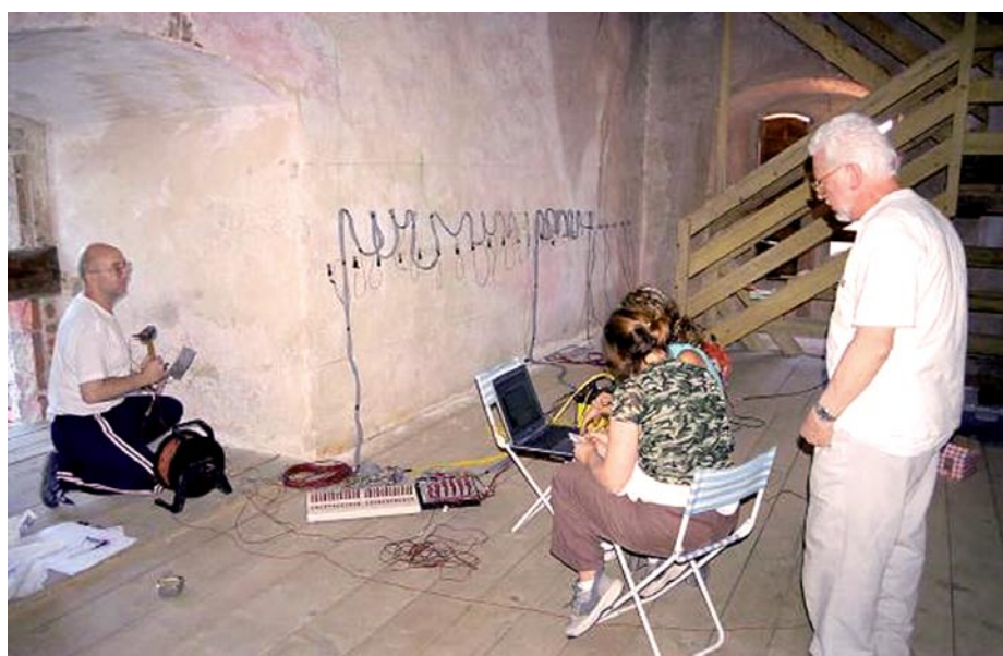
Slika 8 • Ugotavljanje homogenosti kamnitega zidovja z mikroseizmično tomografijo (arhiv ZAG, foto V. Bosiljkov)
