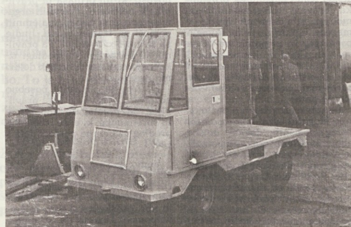
Naše transportno vozilo bo odslej varnejše in voznik je zaščiteno pred slabim vremenom. Kabino so izdelali v naši mehanični delavnici.
