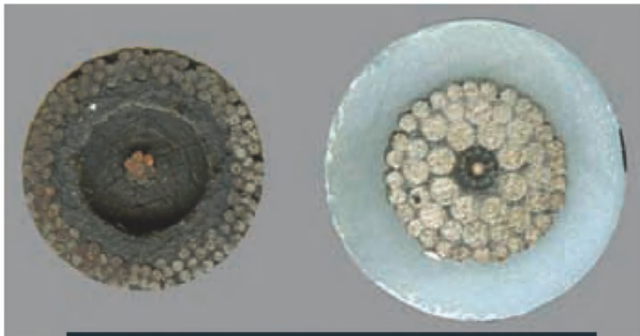
Čeprav danes uporabljamo optična vlakna namesto bakra in polietilensko izolacijo namesto gutaperče (gutta-percha, naravni polimer polilizopren), je prez kablov iz let 1858 (levo) in 2008 (desno) presenetljivo podoben.
