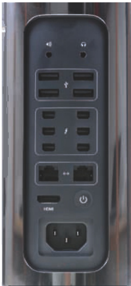
V Applu stavijo na vmesnike Thunderbolt, USB je šele na drugem mestu. Zanimiva je vgradnja dveh gigabitnih omrežnih vmesnikov.
