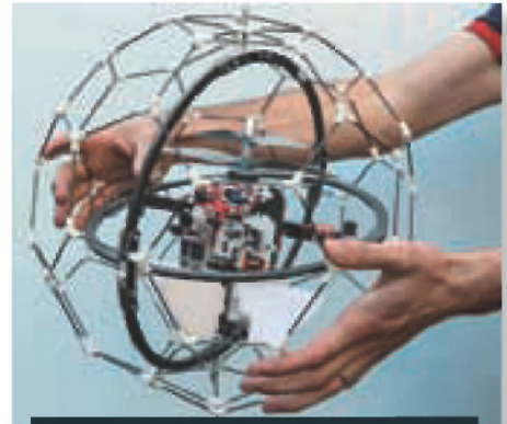
Gimball je domiselni način, kako robotskim helikopterčkom omogočiti letenje tudi ob manjših trkih.
