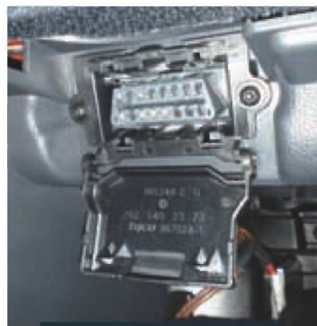
Vtičnica OBD2 je navadno skrita očem, a enostavno dosegljiva v bližini volanskega obroča.
