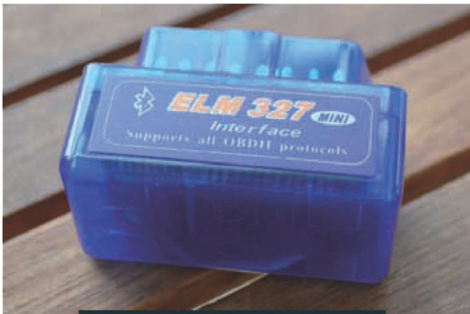
Vmesnik ELM 327, za nekaj evrov dobimo popoln vpogled v delovanje elektronike in tipal avtomobila.
