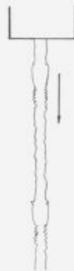
Slika 1: Prikaz elastičnega izbruha pri izhodu kavčukove taline iz kapilare Figure 1: Demonstration of spurring effect upon rubber melt exit from the capillary
