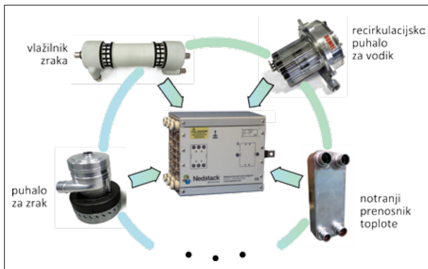
Slika 1. Shema osnovne zasnove sistema s podpornimi komponentami
